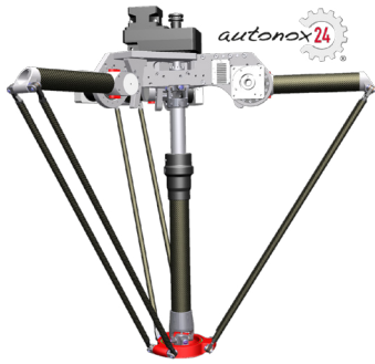
Ein Bestseller im autonox24-Portfolio: Die DELTA Robotermechanik RL4 für eine Nenn-Traglast von 6 Kilogramm.
