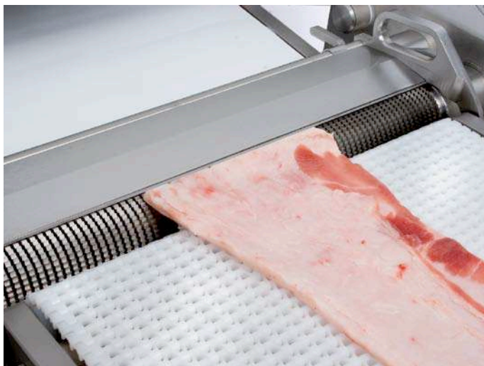
Die Band-Entschwartungsmaschine BXA eignet sich zum vollautomatischen Entschwarten von flachen Teilstücken wie Bauch und Rückenspeck.
