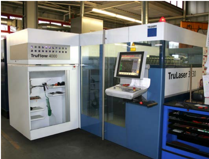
Die Edelstahlbleche für die MAJA-Maschinen werden per Laserstrahl-Technologie präzise und effizient auf Maß geschnitten.
