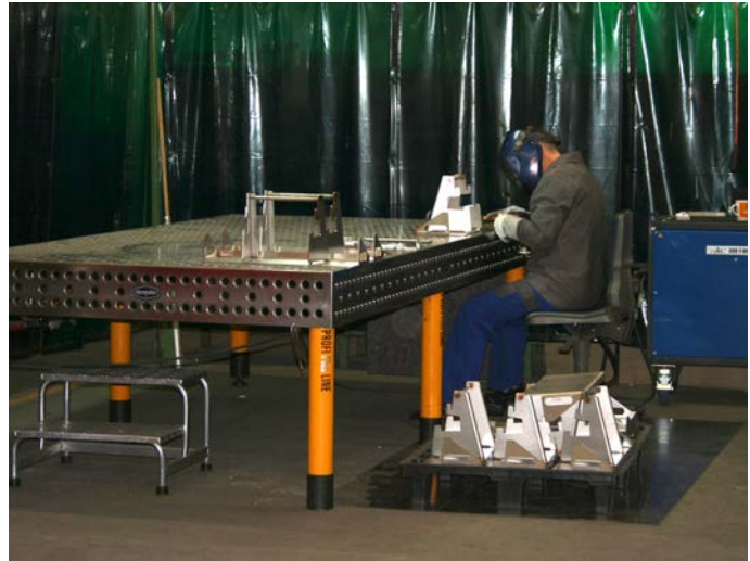
Die vorbereiteten Blechteile werden vor Ort auch zusammengefügt und verschweißt.
